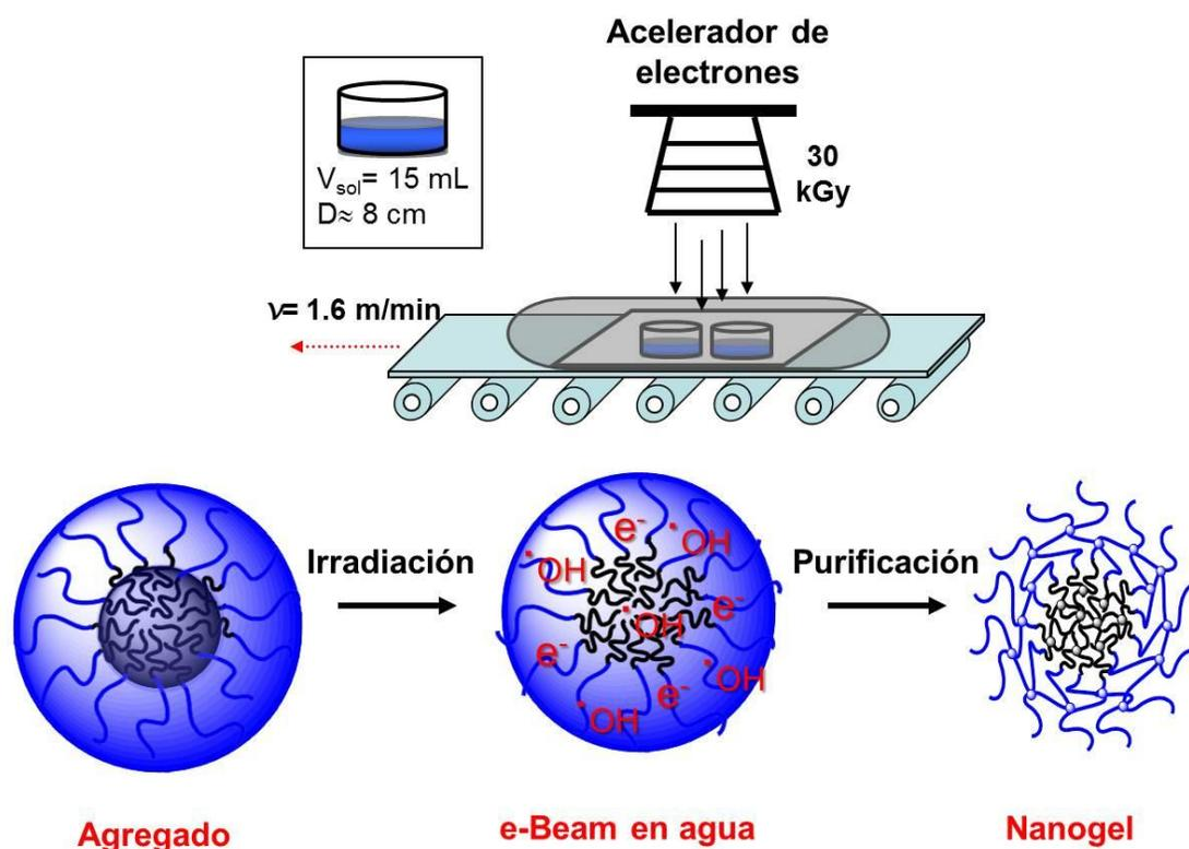
Figura 1: Ruta de síntesis de nanogeles partiendo de micelas poliméricas vía irradiación con electrones acelerados.
